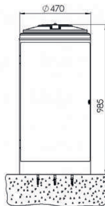
Montage auf Betonfundament
